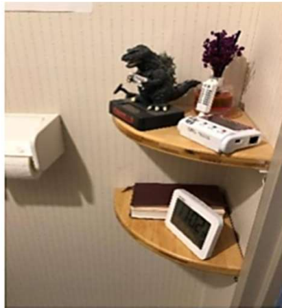
ア)居間、トイレの温湿度計測 (データロガー)
